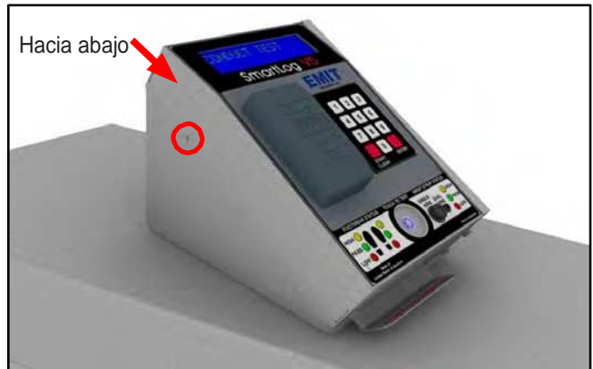
Figura 14. Colocaciopn del SmartLog V5™ en el soporte fijación con el tornillo 4-40
