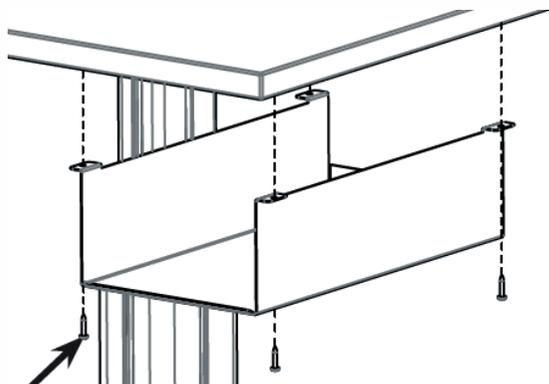
Fijado con tornillos al tablero
