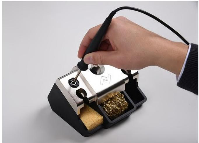
Simplemente coloque el soldador en una de las aberturas provistas. gírelo aprox. 10 ° y podrá quitar la punta de soldadura vieja y aplicar una punta nueva. Esto se puede hacer a mano incluso sin el soporte de depósito y aún caliente.
