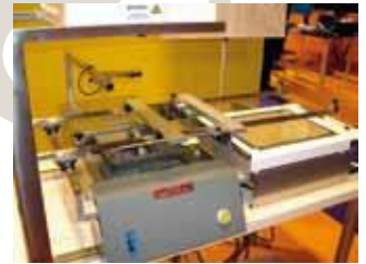
Mini ola MV500 con sistema up/ down and y sistema de transporte x,y
