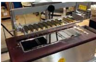
Barra conectora: ejemplo de herramienta montada en un robot (en este caso, herramientas para conectores)
