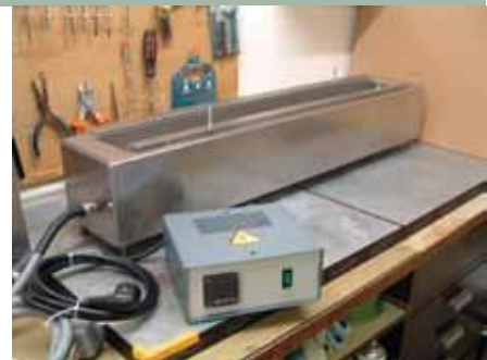
Crisol largo: Ejemplo de crisol largo, de 1,20 m
