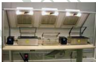
Ejemplo de una estación completa de decapado / fluxado / estañado con pantógrafo
