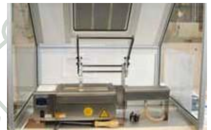
Crisol con pantógrafo : ejemplo de estación con pantógrafo que asegura la transferencia al crisol
