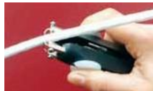
KIT.REG: Permite medir directamente el largo del pelado
