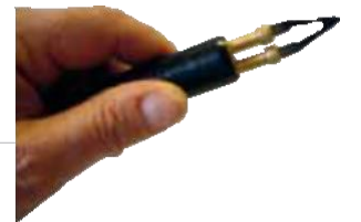
CCT: Cuchillo térmico (corte trenzado, apurados, etc.)
