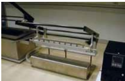
FLUX TRAY: estación de fluxado con pantógrafo, acepta los mismos soportes de componentes que el robot
