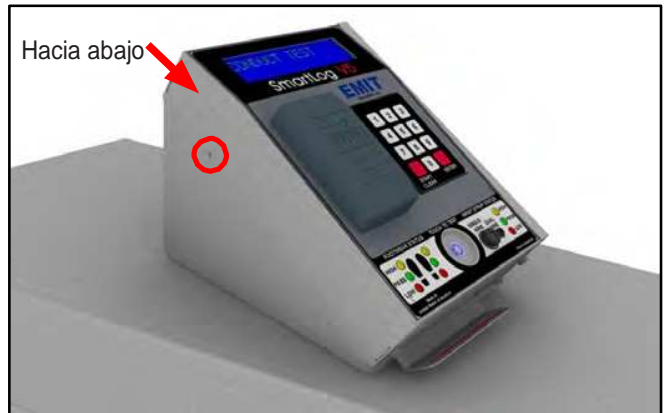
Figura 14. Colocaciopn del SmartLog V5™ en el soporte fijación con el tornillo 4-40
