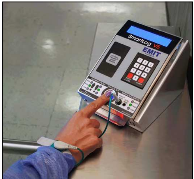
Figura 15. EMIT 50771 Torno en funcionamiento con el SmartLog
