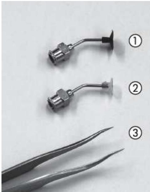
La pipeta de vacío se suministra con 2 tipos de boquillas de succión.
