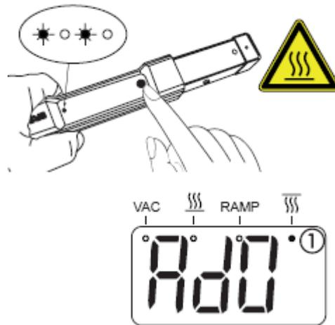
La herramienta híbrida se controla mediante el botón de encendido y apagado en el mango.
