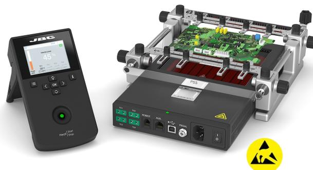
Se pueden conectar hasta cuatro termopares. Se adapta perfectamente a cualquier tipo de PCB gracias a sus componentes ajustables y sus 3 posiciones ajustables de 22, 45 o 65 mm.
