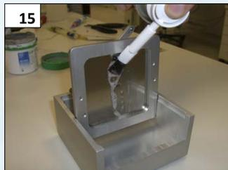
Después de la limpieza, los residuos del limpiador en la base se pueden retirar con una toallita absorbente.
