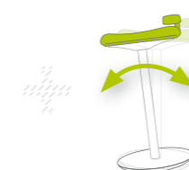
Base basculante. La totalidad de la sección superior puede inclinarse hasta en 7°
