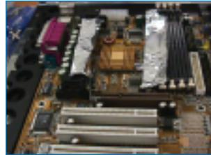
BGA con superficie disipadora
