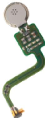
Micrófono y conector de teléfono móvil. Aplicación realizada en el sector de telecomunicaciones. 4 puntos de soldadura por contacto.
