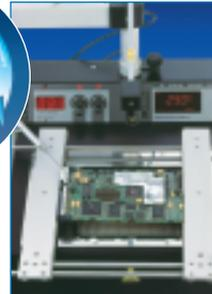
La información obtenida a través de los sensores de infrarrojo ayudan al programa a ajustar el perfil de refusión. El sensor de contacto previene de sobrecalentamiento a los componentes adyacentes.
