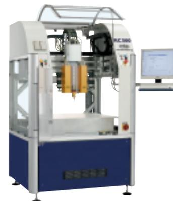
Robot RC-500 para microdispensado.
