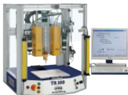
Robot de sobremesa TR-300 para microdispensado.
