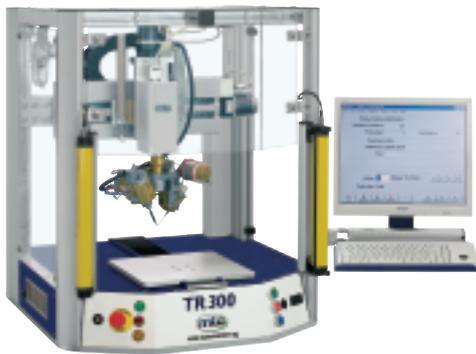
**ROBOT DE SOLDADURA DE SOBREMESA TR-300**
